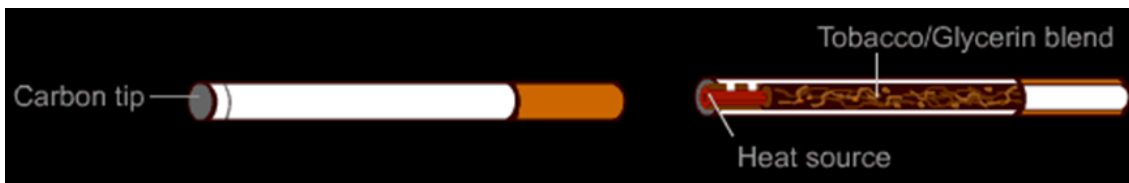
Figura 4. Dispositivo com aquecimento por ponta de carbono. Disponível em:
